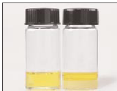
Figura 3. (l) El nanorelleno en el Adhesivo Adper™ Single Bond 2 (botella izquierda en la ilustración) se mantiene en forma de solución; el relleno incorporado en el adhesivo Optibond Solo Plus™ no.
